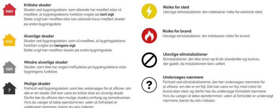
FIG 1: Oversigt over det nye vurderingssystem i tilstandsrapporterne og elinstallationsrapporterne. Kilde: Sikkerhedsstyrelsen.
